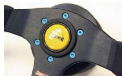
弊社の展開する、競技用チタン合金ボルトシリーズの一部で、社外ステアリングを取り付けるためのボルトです。材質は $\beta$ 153、陽極酸化処理仕上げです。
